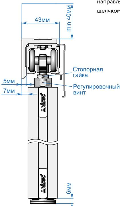
12 Установите дверь. Еще раз отрегулируйте высоту и горизонт. Дверь в нужном положении фиксируется стопорной гайкой на верхнем ролике.
